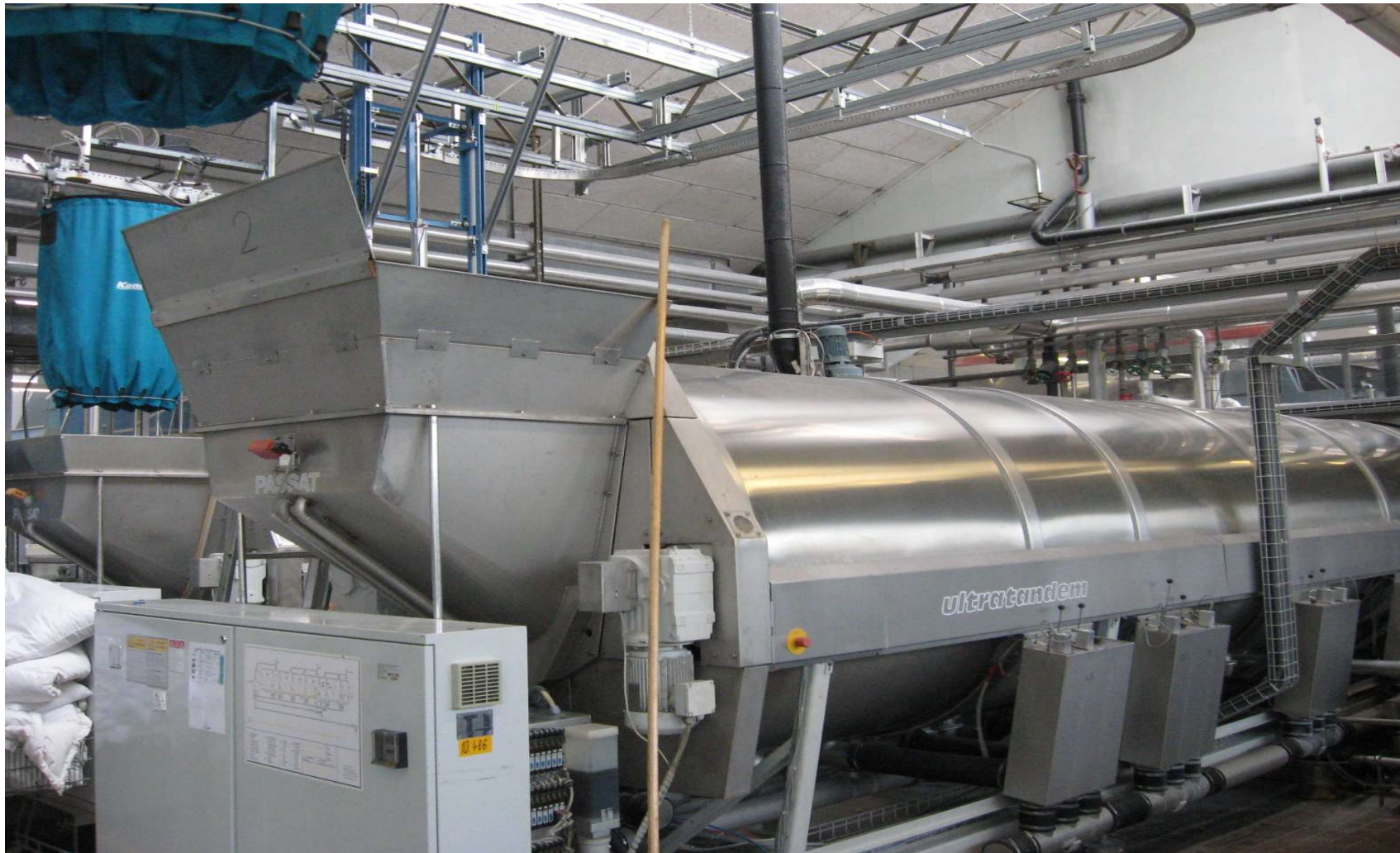
Waschstrasse 13-Kammer 50 kg Waschtemperatur 70°C
